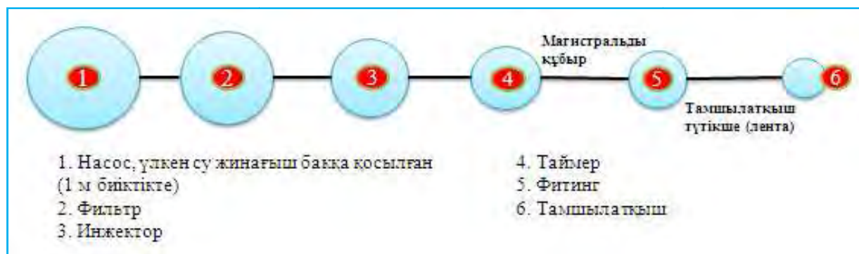
2-сурет – Тамшылатып суару жүйесінің жұмыс принципі
