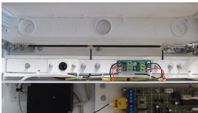
Рисунок 4. Экспериментальная установка для калибровки термопар
