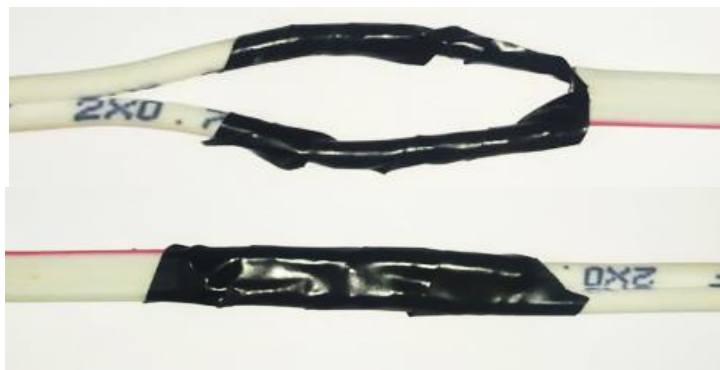
Сурет 61 – Жалғанған сымдарды оқшаулау үлгісі
