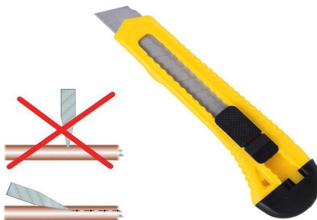
Сурет 53 – Сымдарды аршу кезінде пышақтың жүзін ұстау үлгісі
