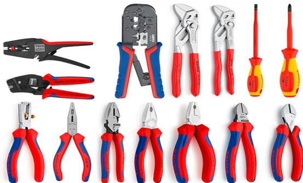
Сурет 52 – Электрмонтаждау құралдары
