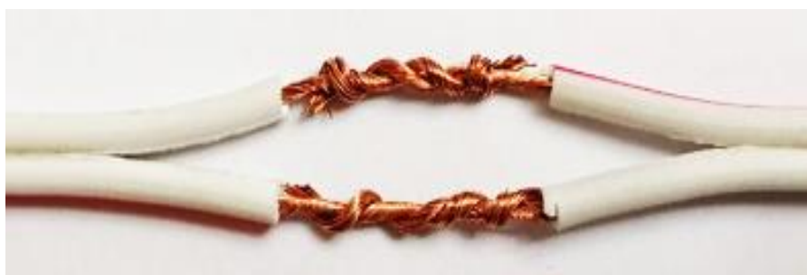
Сурет 60 – Сымдарды шиыршықтап жалғау үлгісі
