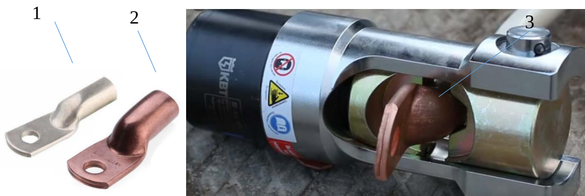
Сурет 63 – Сымның өзегін нығыздау арқылы ұштау реті: 1-ТА типті ұштық; 2-ТАМ типті ұштық; 3-пресс матрицасы және пуансон [157, б.27]
